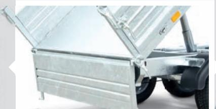
**NEU** **ROBUSTE, FEUERVERZINKTE STAHLBORDWÄNDE**
