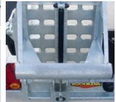
**HEBEVORRICHTUNG FÜR AUFFAHRSCHIENEN**
