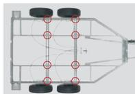
Feuerverzinkter Stahlrahmen mit Längsträgerkonstruktion und V-Deichsel
