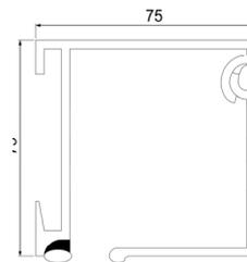
**Kassettenmaße in mm (bei Rollobreite ab 220cm und Rollohöhe ab 250cm)**
