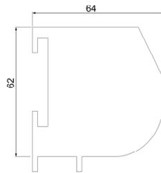
**Kassettenmaße in mm (bei Rollobreite bis 220cm und Rollohöhe bis 250cm)**
