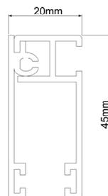
**Maße der seitlichen Führungsschienen in mm**
