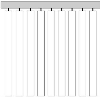
**Bezeichnung:** Vertikallamellen mit 127mm / 89mm Breite
