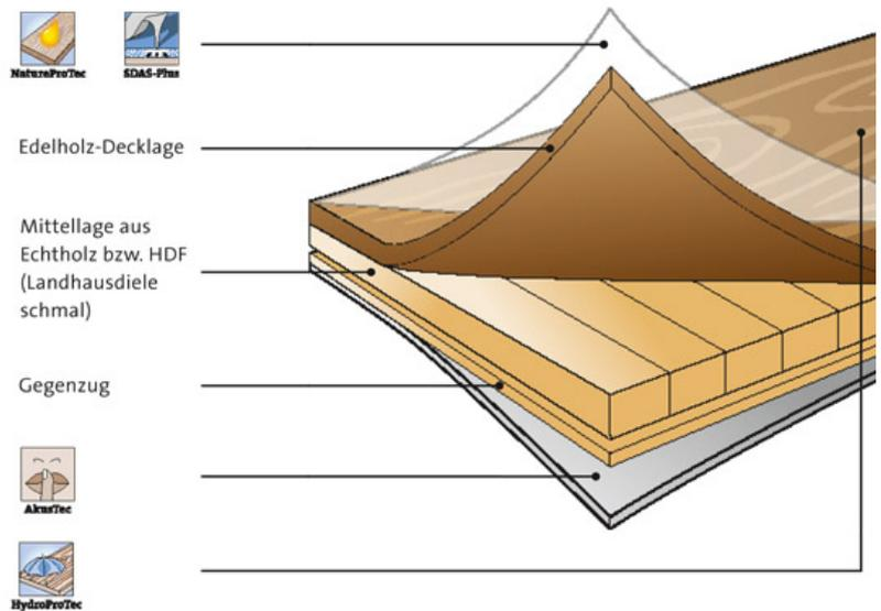
Fertigparkett zeichnet sich durch seinen 3-schichtigen Grundaufbau aus. Die Holzart der Oberfläche beschreibt dabei das Material der Decklage. Mittellage und Gegenzug dienen der Stabilisierung der Diele für eine hohe Belastbarkeit.
