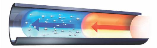
Durch spezielle Additive wird das Reinigungsmaterial von dem Folgematerial sehr einfach und schnell verdrängt.
