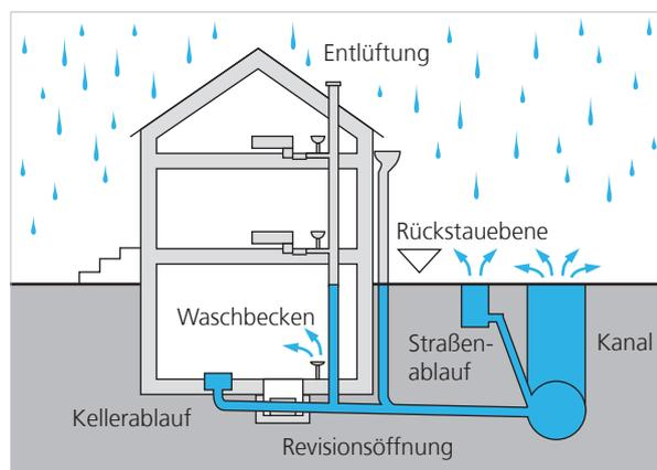
Wasser kann in die angeschlossenen Hausgrundleitungen hinein laufen. Hier wirkt dann das 'Gesetz der kommunizierenden Röhren'. Das heißt, das Wasser steigt theoretisch soweit an, bis es den höchstmöglichen Wasserstand erreicht hat. Dies ist fast immer die Straßenoberkante = Rückstauenebene.
