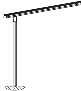
Querbalken zurück versetzt, Wasserkanal vorne
