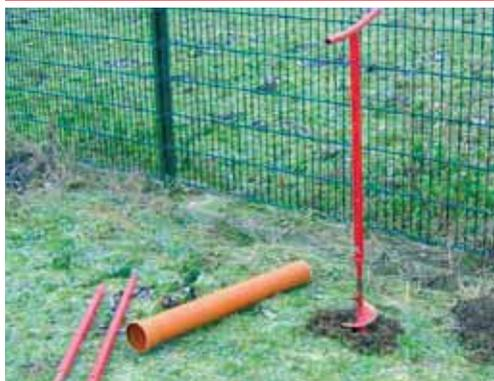
Hand-Bohrer zur Bohrung von Brunnenlöchern in weichem Untergrund. Mit den Verlängerungen kann bis 15 m gebohrt werden.
