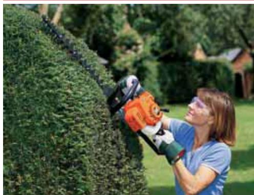
Mit ihrem leistungsstarken Motor ist diese Heckenschere für eine hohe Schnittleistung ausgelegt. Der Messerbalken verfügt über beidseitig geschliffene, gegenläufige Ober- und Untermesser.
