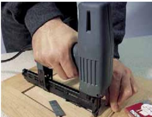
Der starke Elektro-Tacker ist mit einer automatischen, elektronischen Mehrschlagsauslösung und Endabschaltung ausgestattet. Das bedeutet, der Tacker schlägt solange bis die Klammer oder der Nagel versenkt ist. Durch die schmale Nase eignet sich der Tacker besonders für Standardprofilholzkrallen und Paneele.
