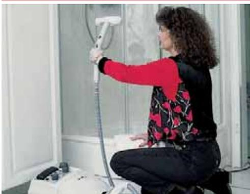
Mit dem Dampfreiniger können Fußböden und harte Flächen, wie z.B. Duschkabinen, Fenster, Armaturen, Fliesen, Dunstabzugauben etc. ganz ohne Chemie gereinigt werden.
