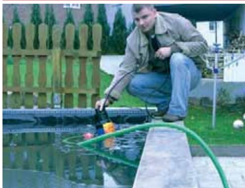
Tauchpumpe für den Haus-, Hof- und Gartenbereich. Sie fördert reines und verschmutztes Wasser mit festen Bestandteilen bis zu einer Korngröße von 15 mm und eignet sich zum Auspumpen von Behältern, Wasserbecken oder überschwemmten Kellern.
