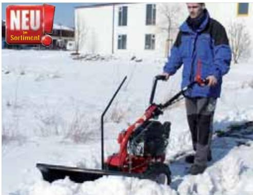
Einachser mit Anbaugerät Schneeräumschild zur Schneebefreiung von kleinen bis mittleren Grundstücken.
