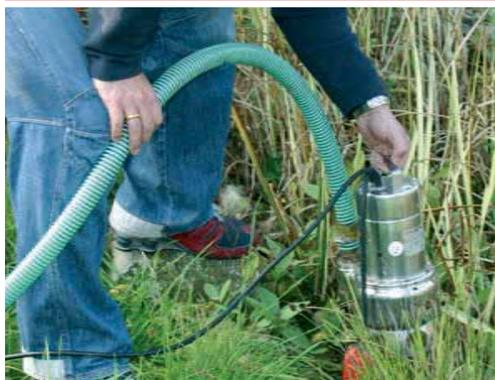
Edelstahl-Tauchpumpe zur Beseitigung von Schmutzwasser mit Feststoffen bis 33 mm Korngröße. Mit Schwimmerschalter für Automatikbetrieb.
