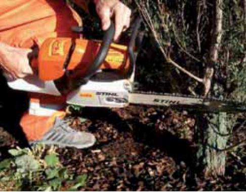
Für das Sägen von Ästen und für Fällarbeiten. Empfohlene Schnittlänge bis 20 cm. Nicht in geschlossenen Räumen verwenden!
