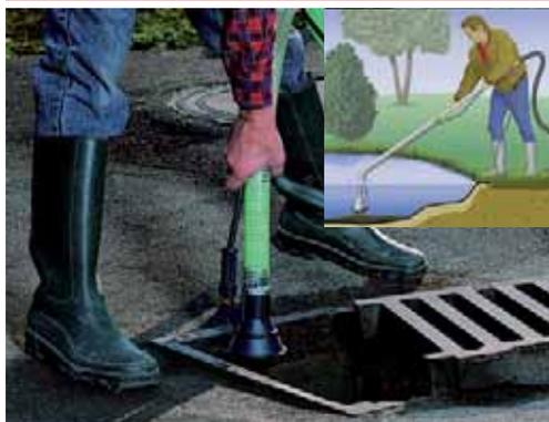
Der Schlammsauger in Verbindung mit einem Hochdruckreiniger ist geeignet zum Reinigen von Pools, Absaugen von Teichschlamm, Entleeren von Gruben usw.
