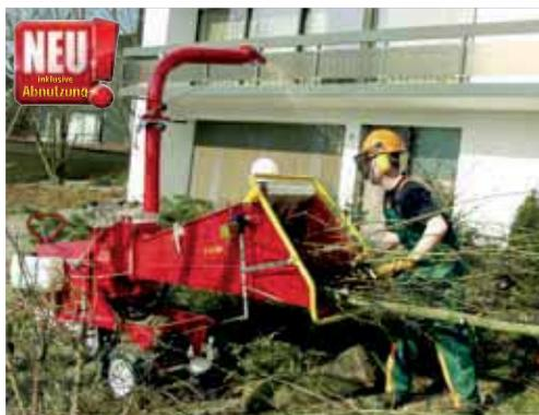
Durch den großen Einzugtrichter und seinen hydraulischen Einzug kann der Häcksler bequem „gefüttert“ werden. Selbst kleine Baumstämme bis 11 cm Durchmesser verarbeitet der Häcksler ohne Mühe. Der Häcksler ist auf einem schmalen Zugwagen aufgebaut.
