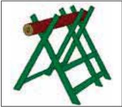
Lose Äste und Stämme gegen Verdrehen sichern! Die Sägekette kann Äste und lose Teile mitreißen.
