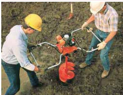
Starkes Zweimann-Erdbohrgerät zur Bohrung von Erdlöchern für Zäune, Bäume, Sträucher und Jungpflanzen. Die Bohrtiefe richtet sich nach dem geologischen Untergrund.
