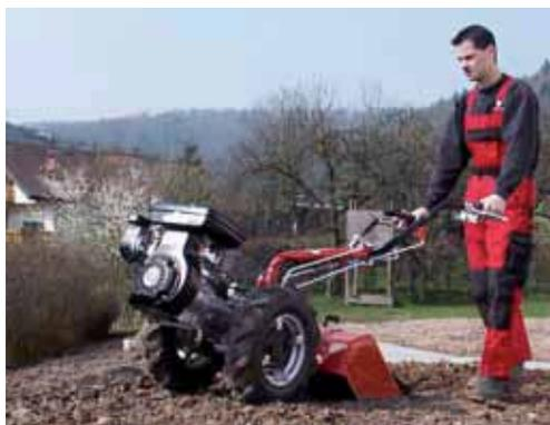
Dieses Gerät ist optimal zum Bearbeiten von Rasenumbrüchen und Aufarbeiten von schweren, verdichteten Böden geeignet. Durch das Sperrdifferenzial kann auch an engen Stellen optimal manövriert werden.
