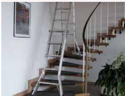
Diese vierteilige teleskopierbare Alu-Gelenkleiter ist einsetzbar als Steh- und Anlegeleiter. Durch die teleskopartige Verschiebung der äußeren Leiternteile von Sprosse zu Sprosse und die Möglichkeit des Auszugs der 4 integrierten Holmverlängerungen passt sich die Leiter den unterschiedlichsten Einsatzbereichen (Treppen, Absätzen, Bodenebenenheiten etc.) an.
