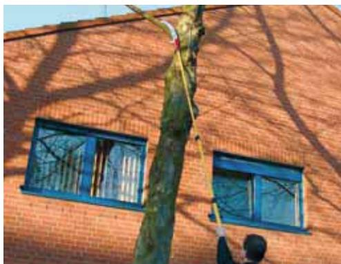
Mit dieser Hand-Astsäge können bei ausgefahrenem Teleskoprohr Schnitte in 7 m Höhe ausgeführt werden. Das Spezial-Sägeblatt ermöglicht einen schnellen und mühelosen Schnitt.
