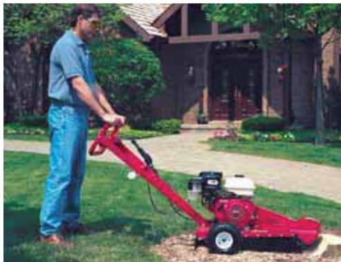
Leichtes und handliches Gerät zum Fräsen von Baumstümpfen bis 13 cm unterhalb der Erdoberfläche.
