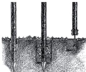
tiefes Loch (20 x 20 cm) ausgehoben wurde. Mit einem Loch-eisen wird dann der Boden so tief wie möglich gelockert, damit der Pfosten je nach Zaunhöhe ca. 50 bis 70 cm tief in den Boden kommt.
