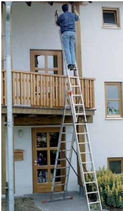
Diese Leiter kann als Anlege-, Schiebe-, Steh-, Treppen- und Böschungsleiter eingesetzt werden. Die Verarbeitung entspricht höchsten Anforderungen und gewährleistet höchste Sicherheit.
