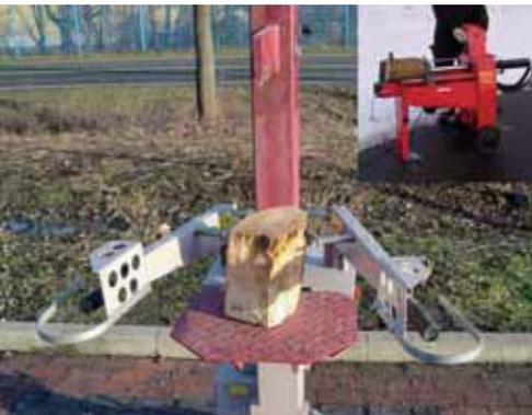
Mit dem stufenlos verstellbaren Holzspalter können Stammdurchmesser bis zu 50 cm mühelos gespalten werden. Die Zweihand-Sicherheitsbedienung bietet maximale Sicherheit.
