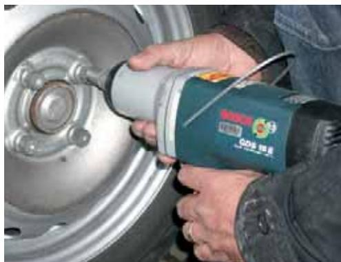
Der Schlag-Schrauber ist zum Verschrauben von 6-kant-Schrauben oder Muttern geeignet.
