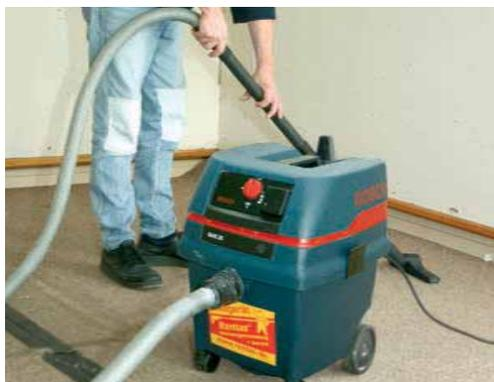
Industriesauger zum Aufsaugen von Stein- und Feinstäuben. Zur Staubabsaugung an Elektrowerkzeugen mit Staubsaugeranschluss.
