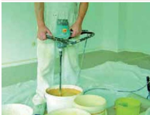
Rührwerk mit synchronisierter 2-Gang-Schaltung zum Rühren von Farben, Lacken, Kleber, Mörtel u.a.m. Optimale Anpassung der Drehzahl an das Rührgut.
