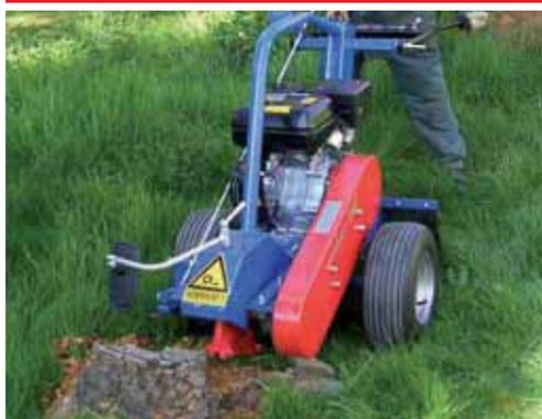
Das Gerät fräst in kürzester Zeit Stümpfe bis 20 cm unterhalb der Erdoberfläche einfach weg. Danach wird die Vertiefung mit Erde verfüllt. Die restliche Wurzel bleibt in der Erde und verrottet.
