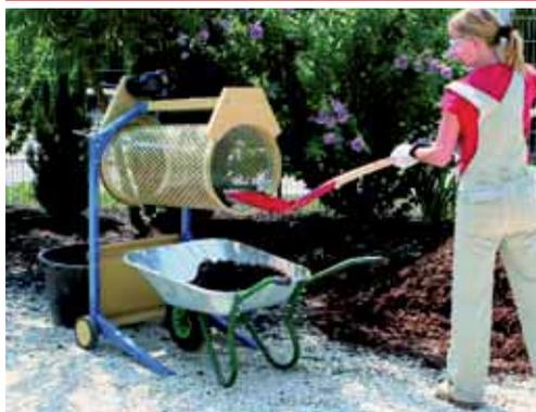
Mit dem Rollsieb können unterschiedliche Arbeiten wie z.B. Durchmischen verschiedener Bodensorten, Entsteinen von Erdreich, usw. durchgeführt werden.
