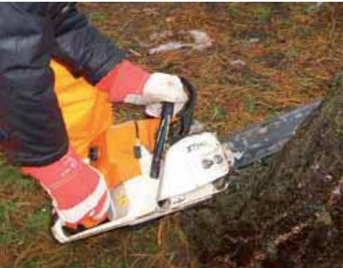
Für das Sägen von Ästen und für Fällarbeiten. Empfohlene Schnittlänge bis 40 cm. Nicht in geschlossenen Räumen verwenden!
