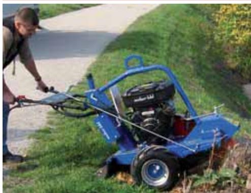
Das Gerät fräst in kürzester Zeit die Stümpfe bis 20 cm unterhalb der Erdoberfläche einfach weg. Danach wird die Vertiefung mit Erde verfüllt. Die restliche Wurzel bleibt in der Erde und verrottet. Das Gerät hat eine hydraulischen Fahrtrieb.
