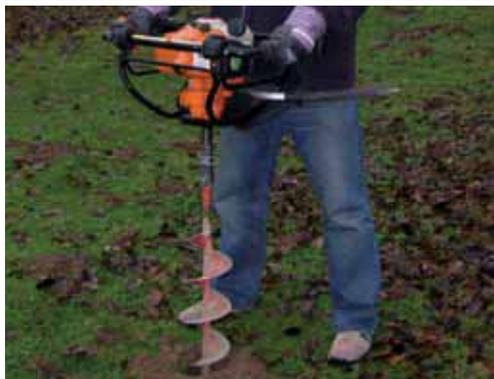
Leichtes Einmann-Erdbohrgerät zur Bohrung von Erdlöchern für Zäune, Bäume, Sträucher und Jungpflanzen.
