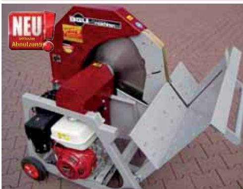
Diese leistungsstarke Wippkreissäge sägt Ihr Holz mühelos mit einem Durchmesser bis zu 280 mm. Durch den 9 PS starken Benzin-Motor sind Sie orts- und stromunabhängig, ein leichter Transport ist durch das Fahrwerk überall möglich.
