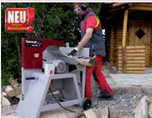
Diese Wippkreissäge kann Holz mit einem Durchmesser bis zu 260 mm sägen, im Wendeschnitt bis 380 mm.
