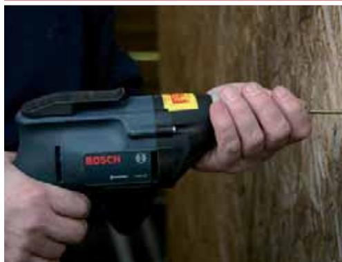
Universell einsetzbarer Bohrschrauber. Schlanker Tiefenanschlag, abnehmbar, ohne die vorgewählte Tiefe zu verändern. Magnetischer Universalhalter für sicheren Halt der Schraube.
