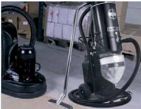
Hochleistungstrockensauger für den Einsatz bei großen Schmutzmengen. Besonders geeignet für die Bodenschleifmaschine für Beton, Estrich und Holz (S. 18).
