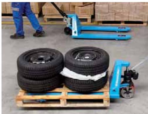
Gabelhubwagen für den Transport von Lasten und Paletten bis zu einem Gewicht von 2,5 Tonnen. Aufnahme für Europaletten.
