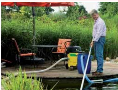
Der Teich-Schlammsauger kann Feststoffe und Sand vom Boden absaugen, sowie auch Blätter, Algenester und Schlamm. Durch den zwischengeschalteten Vorabscheider werden die Stoffe aufgefangen. Das Gerät arbeitet kontinuierlich und pumpt das abgesaugte Schmutzwasser sofort ins Freie. Alle Anschlüsse sind C-Anschlüsse.
