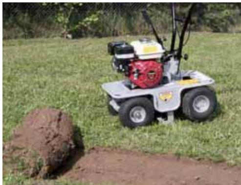
Mit dem Rasensodenschneider schneiden Sie Bahnen wie bei der Rasensodenproduktion, rollen diese zusammen und tragen sie ab. Durch das leichte Gewicht und die einfache Bedienung kann der Rasensodenschneider in jeder Anlage eingesetzt werden.
