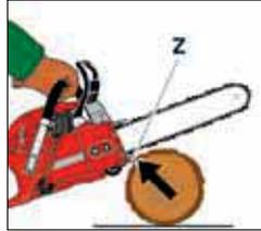
Zackenleiste [Z] fixiert die Motorsäge. Hebelarm nutzen.
