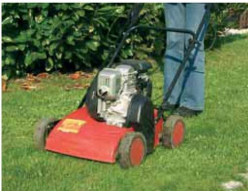
Mit dem Vertikutierer entfernen Sie mühelos Moos und Rasenfilz aus dem Rasen. Empfohlen für Flächen über 250 qm.
