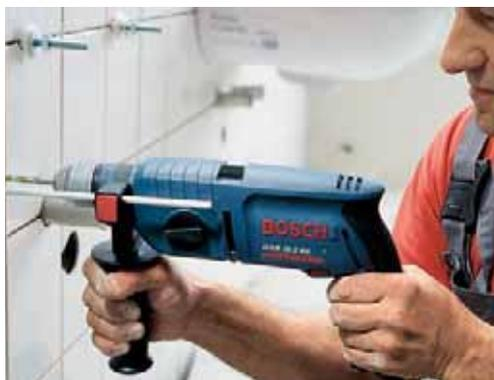
Robuste und kraftvolle 2-Gang-Schlagbohrmaschine mit Rechtslinks-Lauf und Überlastkupplung für schwere Bohr- und Schraubarbeiten, Hohlbohrkronen und Lochsägen
