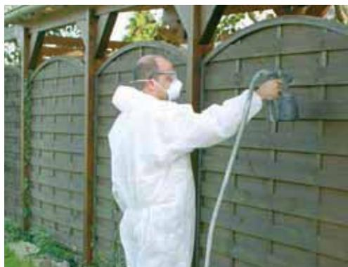
Elektrisches Farbspritzgerät zum Verarbeiten von lösungsmittelhaltigen und wasserverdünnbaren Lackfarben sowie von Holzschutzmitteln. Das Gerät kann auf waagerechten und senkrechten Flachstrahl sowie auf Rundstrahl eingestellt werden.
