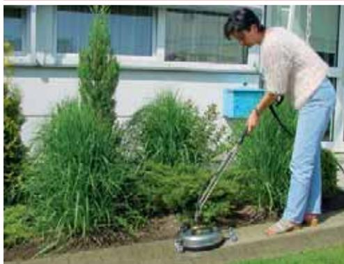
Anstelle der Sprühdüse kann beim Hochdruckreiniger der „Terrassenreiniger“ angebaut werden. Damit können ebene Flächen, wie Terrassen oder Balkone, spritzwasserfrei gereinigt werden.
