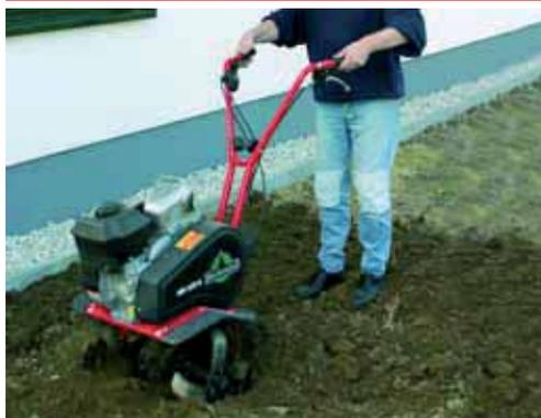
Eine relativ leichte Motorhacke, die aber auch große Flächen bearbeiten kann. Geeignet für Gartenland und erdigen Boden. **Nicht für verdichtete Böden geeignet.**
