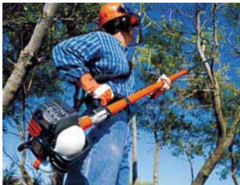
Die kleine Benzin-Motorsäge eignet sich ideal zum Ausasten der Bäume und zum Rückschnitt bei Obstbäumen. Mit der Schaftrohrverlängerung lässt sich vom Boden aus bis zu einer Höhe von 5 m mühelos arbeiten.
