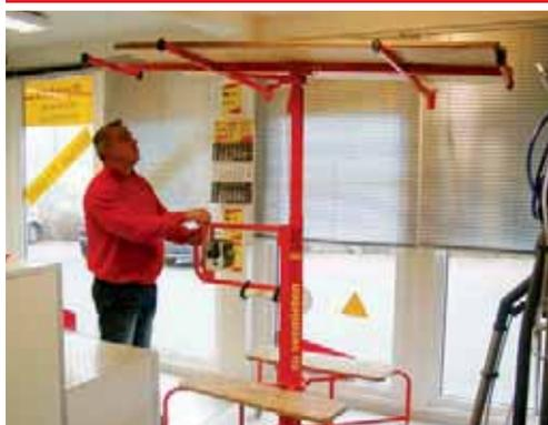
Ideale Hilfe zum Montieren von Trockenbauplatten an Decken und Schrägen. Der faltbare Plattenlift lässt sich leicht im Kombi transportieren, durch seine Auflagen entfällt das lästige Besteigen einer Leiter.
