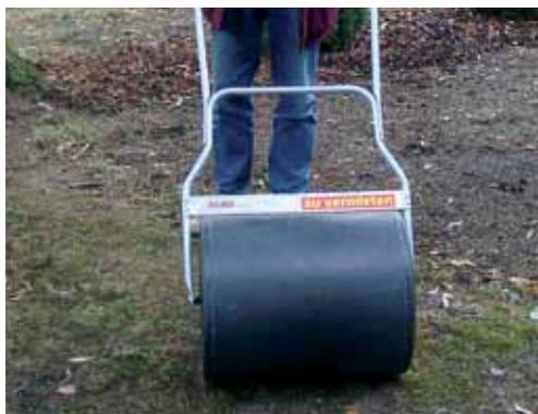
Die Rasenwalze dient zum Walzen der Erde nach dem Einsäen des Rasen-Saatguts und zum Andrücken von neu verlegtem Rollrasen.
