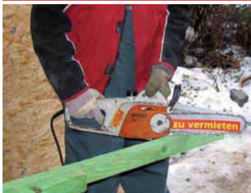
Für das Sägen von trockenem Bau- und Kantholz. Empfohlene Schnittlänge bis 10 cm. Auch in geschlossenen Räumen einsetzbar.
