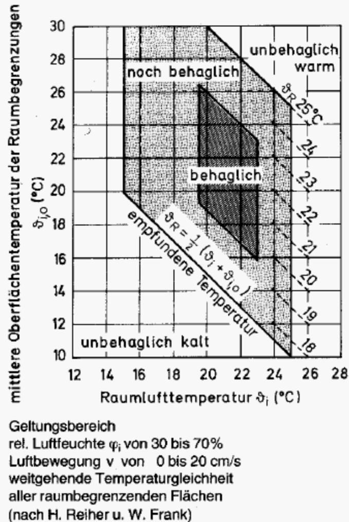
**Bild 1.7: Strahlungstemperatur-Lufttemperatur-Diagramm**
