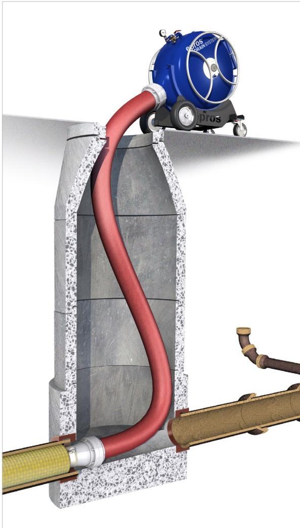
Eine Sanierung mittels Inliner (Schlauchliner) wird vermehrt dort eingesetzt wo der Abwasserkanal Streckenschäden aufweist bzw. eine größere Distanz in einem Arbeitsschritt saniert werden soll. Zudem können Leitungen trotz mehreren Bögen sowie Nennweitenveränderungen (z.B. von DN 100 nach DN 150) saniert werden. Ein Schlauchliner ist bereits ab DN 50 und 87°-Bögen einsetzbar.
