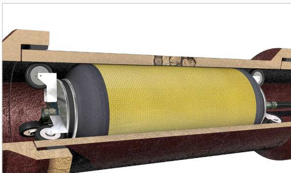
Hiermit können schadhafte Rohrverbindungen, punktuelle Riss- und Scherbenbildung sowie ausgebrochene Rohrstücke, ab DN35 und bis zu einer Länge von fünf Metern, schnell und kostengünstig repariert werden.
