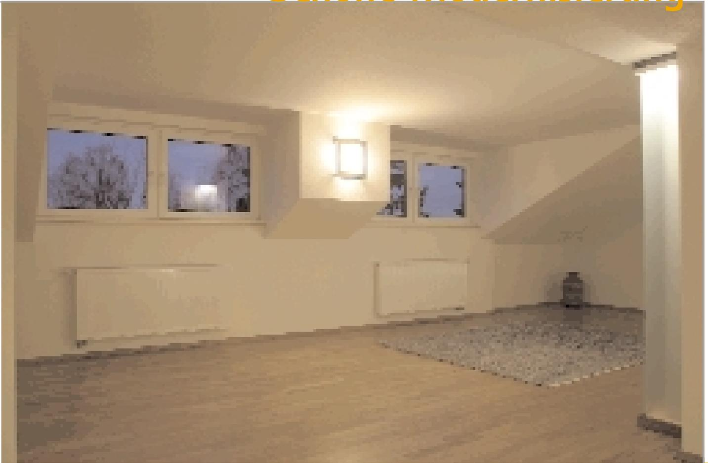
Durch den erhöhten Kniestock und die beiden Gauben zur Gartenseite des Hauses wurde unter dem Dach mehr Stehhöhe gewonnen. Jetzt kann der Raum als vollwertiges Zimmer genutzt werden. Von hier aus bietet sich ein erhabener Blick in die Wipfel der Bäume.
