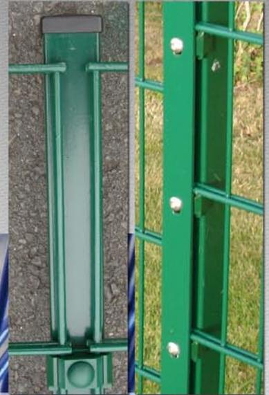
Die Zaunpfosten Typ „Massiv“ haben eine durchlaufende Klemmleiste und eine in Pfostenfarbe mitbeschichtete Alu-Kappe, die im Pfosten vor dem Herausziehen gesichert ist.
